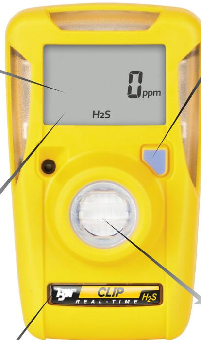
Die benutzerfreundlichste Umgebung. Durch die Eintastenbedienung ist der BW Clip kompakt, leicht und benutzerfreundlich, aber gleichzeitig robust genug für raue Umgebungen und extreme Temperaturen. Und dank des weitwinkligen Blitzes sowie des akustischen und Vibrationsalarms werden Sie selbst bei schwierigen Bedingungen über Alarme informiert.
