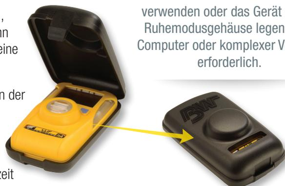
Wenn Sie den Detektor in den Ruhezustand versetzen möchten, können Sie entweder IntelliDoX verwenden oder das Gerät in das Ruhemodusgehäuse legen. Kein Computer oder komplexer Vorgang erforderlich.
